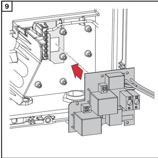
Den Print in den Wechselrichter einsetzen.
