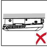
Den Wechselrichter nicht an der Decke montieren.
