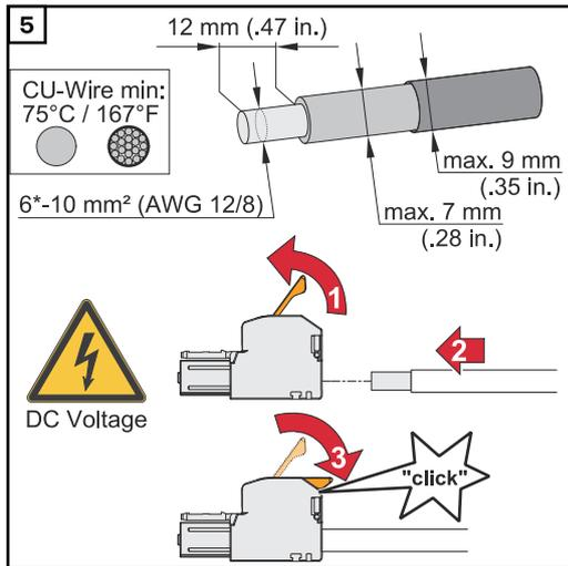
Kabel-Querschnitt gemäß der Angaben in [Zulässige Kabel für den elektrischen Anschluss](#) ab Seite 68 wählen. Von den Einzelleitern 12 mm abisolieren. Den Betätigungshebel der Anschlussklemme durch Anheben öffnen und den abisolierten Einzelleiter in den jeweils vorgesehenen Steckplatz bis zum Anschlag in die Anschlussklemme stecken. Danach den Betätigungshebel bis zum Einrasten schließen.
