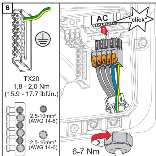
Die AC-Anschlussklemme in den AC-Steckplatz stecken, bis diese einrastet. Die Überwurfmutter der Kabelverschraubung mit einem Drehmoment von 6 - 7 Nm befestigen.
