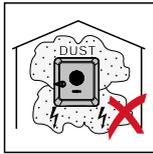
Grundsätzlich ist der Wechselrichter staubdicht (IP 66) ausgeführt. In Bereichen mit starker Staubansammlung können sich Staubablagerungen auf den Kühlflächen ansammeln und somit die thermische Leistungsfähigkeit beeinträchtigen. In diesem Fall ist eine regelmäßige Reinigung erforderlich siehe Kapitel [Betrieb in Umgebungen mit starker Staubentwicklung](#) auf Seite 185. Eine Montage in Räumen und Umgebungen mit starker Staubentwicklung ist daher nicht zu empfehlen.
