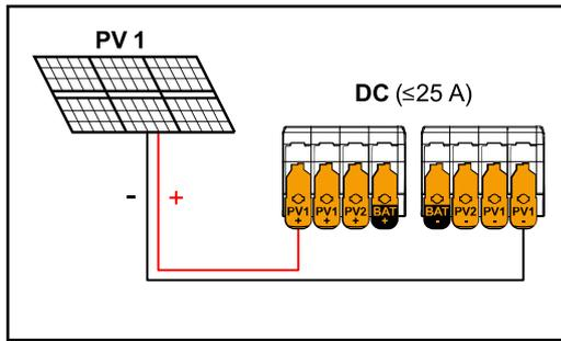
Strom kleiner/gleich 25 A ( $I_{dcmax}$ ).
