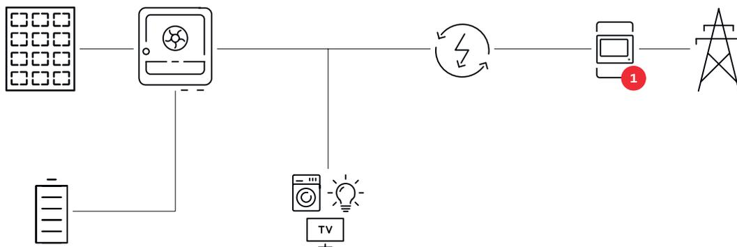
**Betriebsmodus - Wechselrichter mit Batterie und Ohmpilot**
