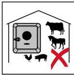
Den Wechselrichter nicht montieren in:
